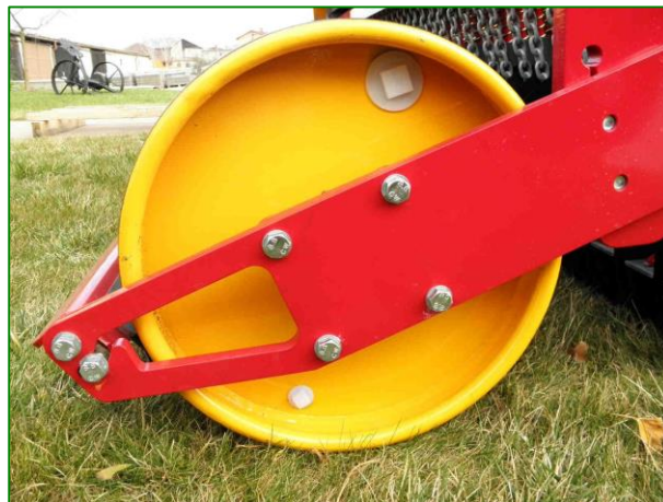
Detail hladkého utužovacího válce (lze plnit vodou)
